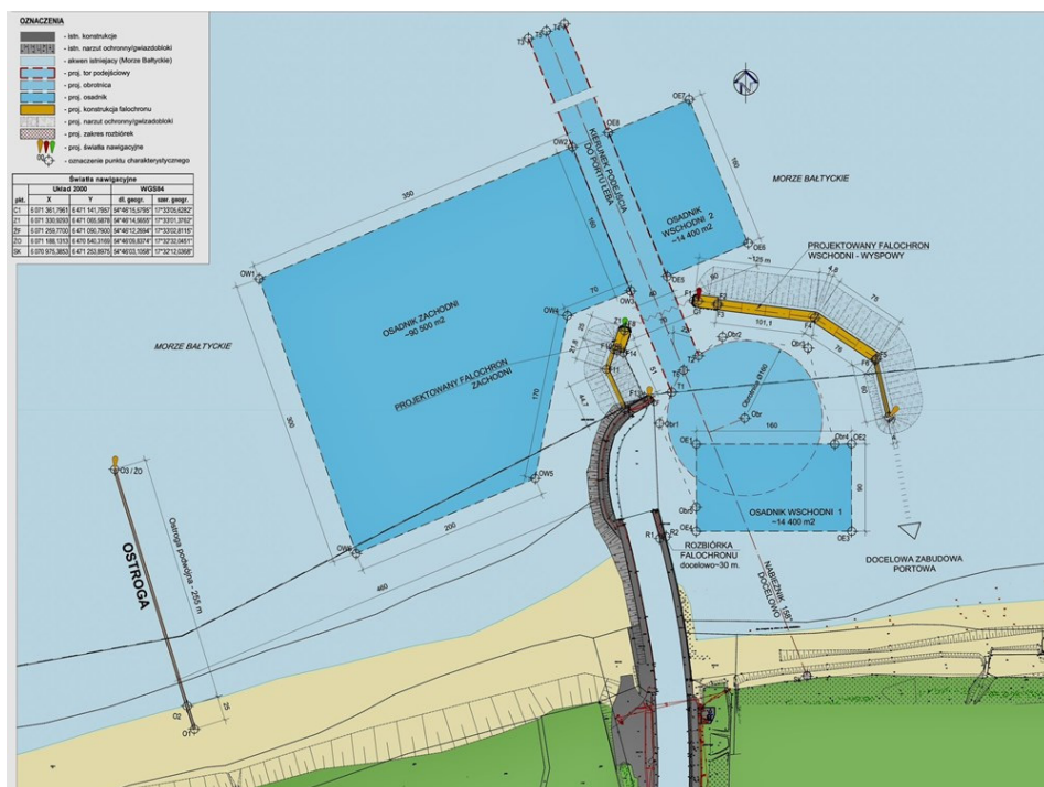
Rysunek 5. Plan przebudowy wejścia do portu w Łebie
